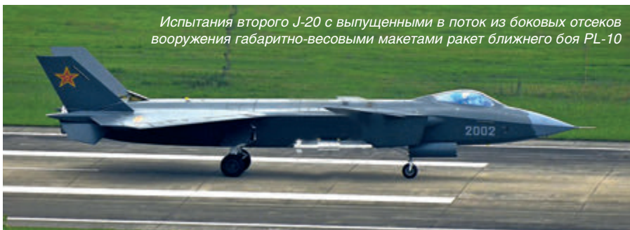
Второй J-20 в испытательном полете с открытыми створками основного отсека вооружения, в котором размещены габаритно-весовые макеты ракет PL-15
